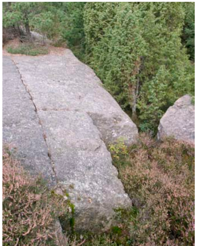
III. 16. Ytterligare ett exempel på förarbeten till blockuttag som inte blivit genomförda. Brott 46 är ett tydligt exempel på kilning med bredkilar där naturliga sprickor använts. Brottet är mycket pedagogiskt och bör kunna bevaras inom planområdet. Foto mot nordväst.
