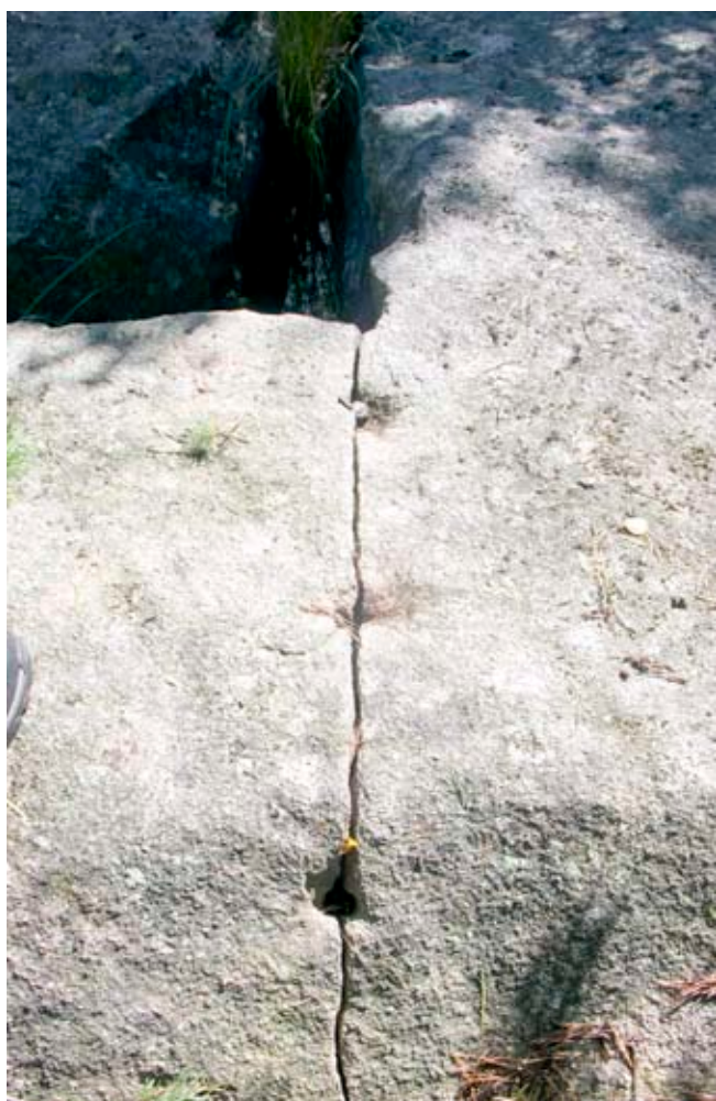
Ill. 9. Söm med kvarsittande rundkilar i en del av kilhålen, stenbrott 3. Foto mot öster.
