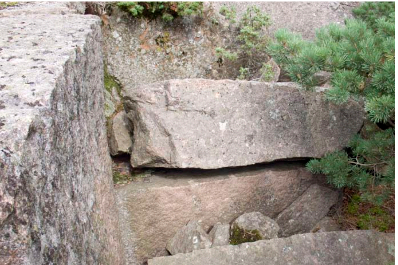
III. 7. Stenbrott 39 var ett av få där horisontella kilhål förekom. Att kila horisontellt är svårt och arbetskrävande varför stenhuggaren försökte undvika det och istället utnyttja naturliga sprickbildningar. Foto mot norr.
