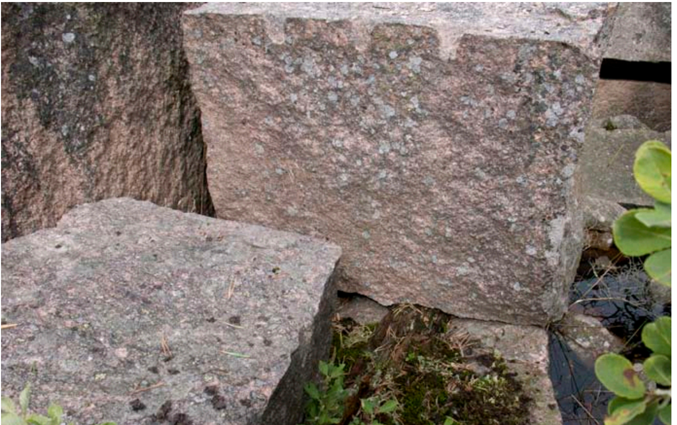
III. 14. I brott 39 ligger detta block kvar, upplagt på nästan borttruttat trä. Blocket är alltså inte skrotat utan har lagts här i väntan på bearbetning. Foto mot norr.
