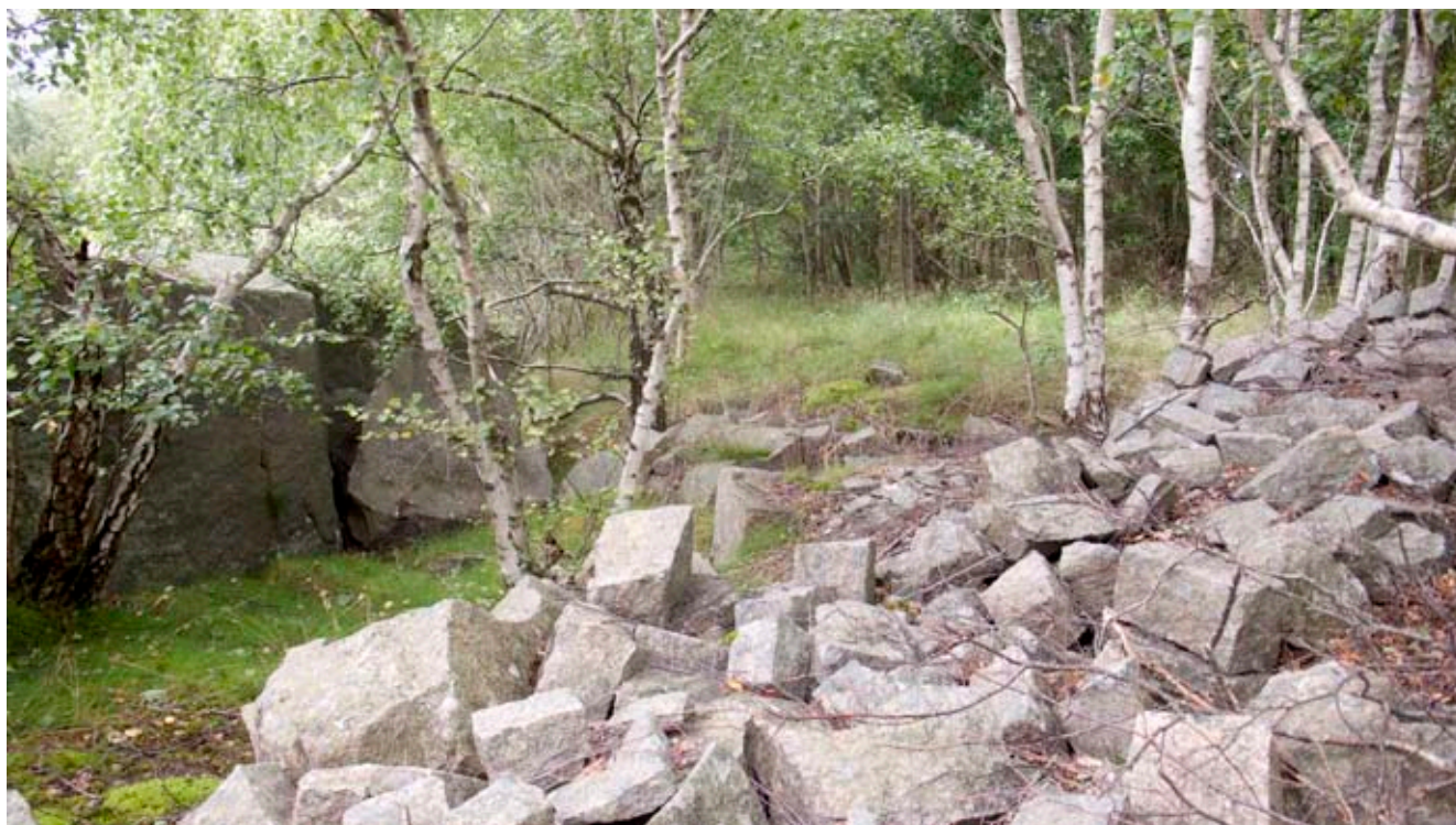
Ill. 17. Vid brott 47 har tillverkningen framför allt omfattat gatsten, av avfall och skrot att döma. Notera tillhuggningsfundamentet i mitten av bilden. I bildens högra del syns i bakgrunden en del av dumpmassorna. Foto mot väster.
